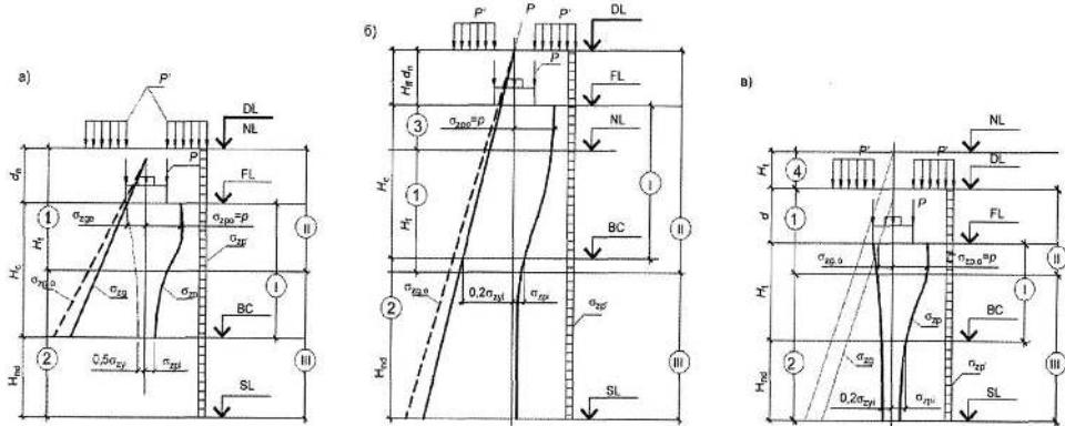
$DL$  - отметка планировки;  $NL$  - отметка поверхности сложившегося рельефа;  $FL$
