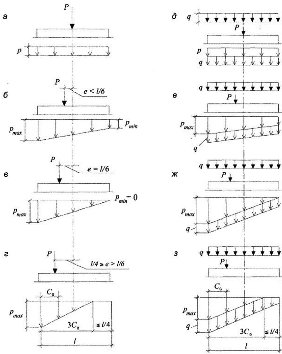
а-г - при отсутствии нагрузок на полы; д-з - при сплошной равномерно распределенной нагрузке интенсивностью  $q$ ; а и д - при центральной нагрузке; б и е - при эксцентриситете нагрузки  $e < l/6^*$ ; в и ж - при  $e = l/6^*$ ; г и з - при  $e > l/6^*$
