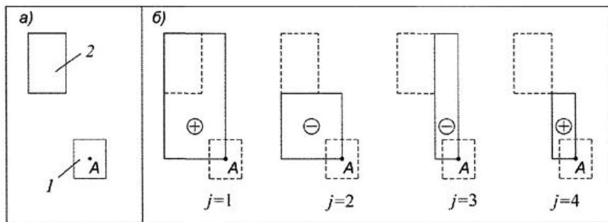
а - схема расположения рассчитываемого 1 и влияющего фундамента 2; б - схема расположения фиктивных фундаментов с указанием знака напряжений
